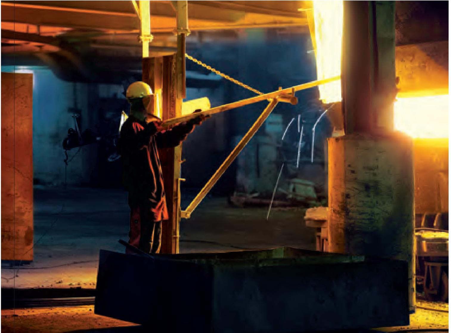
Herstellung von Siliciummetall in Holla. Den bis zu 2.000 Grad Celsius heißen Öfen, die mit Strom beheizt werden, können sich die Mitarbeiter nur in spezieller Schutzkleidung nähern.
